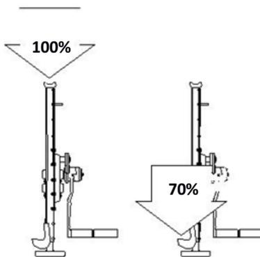
**Рисунок 3. Грузоподъемность домкрата.**
