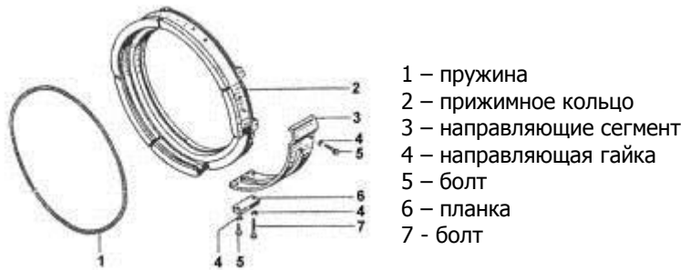
Рисунок 6. Канатоукладчик – развернутый вид.
