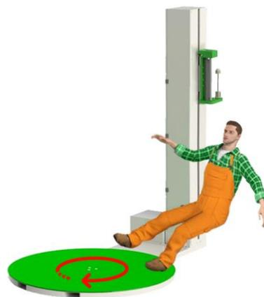
Опасность получения удара и падения: **НИКОГДА** не включать рабочий цикл при наличии людей в непосредственной близости от станка. **НИКОГДА** не включать рабочий цикл, если груз не отцентрован или взаимодействует с внешней частью станка.
