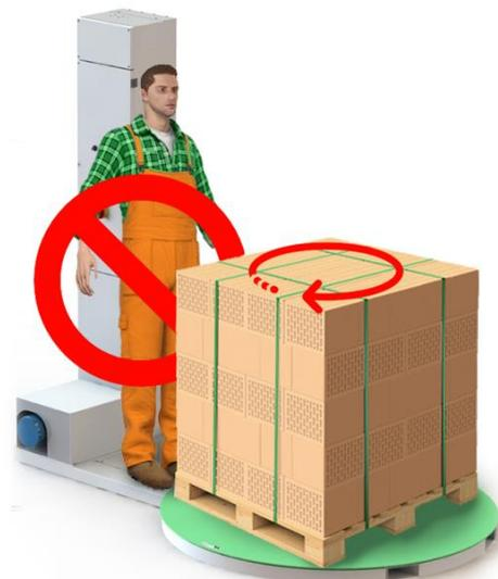
Опасность раздавливания: не стойте в рабочей зоне машины и под кареткой
