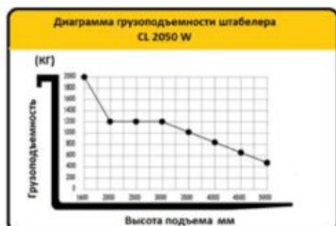
Рисунок 5. Диаграмма грузоподъемности штабелера.
