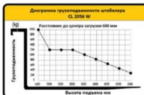
Рисунок 5. Диаграмма грузоподъемности штабелера.
