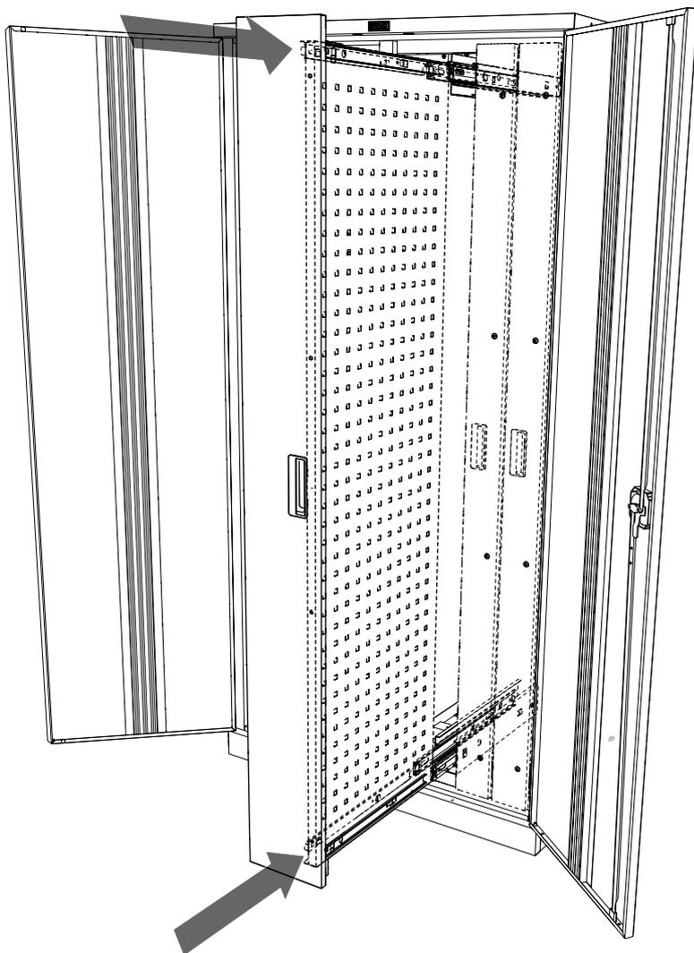
Вставлять колонны необходимо при до упора выдвинутых шариковых сепараторов направляющих !
