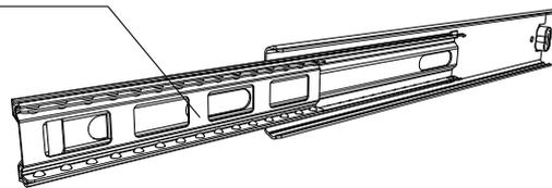
Совместите внешние и внутренние части направляющих и задвиньте колонну до щелчка каждой из четырех направляющих. Повторите операцию для каждой колонны.
