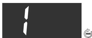
Нет связи термодатчиком, неисправен или обрыв провода термодатчика.
