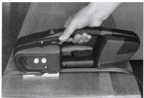
5. После окончания спаивания, светодиод мигает в течение примерно, двух секунд. Не снимайте инструмент с ленты в это время.
