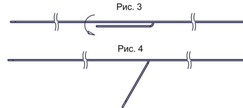
Продеваем язычки в крышку верхнюю (1), затем согнув стенку, просовываем язычки в крышку нижнюю (2). Догоняем язычок для захода в паз полки (3).
