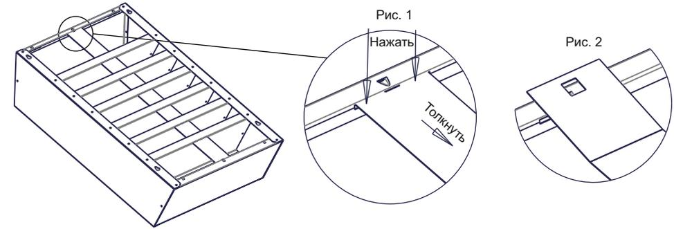
Переворачиваем почтовый ящик дверями вниз. В верхней части нажать на планку заднюю по краям, выводя из зацепления и толкнуть вниз (см. рис.1). Слегка подогнуть стенку, чтобы она легла на крышку (см. рис.2). Повторяем для нижнего зацепления (см. рис.1) и вытаскиваем планку.
