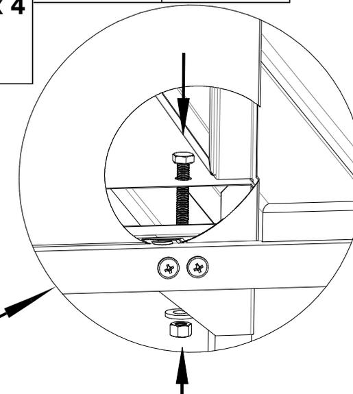
Установите шкаф на подставку и закрепите его с помощью болтов M8x60, шайб M8, гаек M8 (в передней и задней части шкафа)
