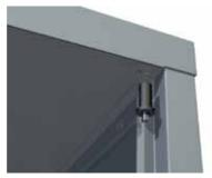
13. Самую верхнюю дверь надеть нижним отверстием на нижнюю ось. Затем «утопив» подпружиненный металлический наконечник верхней оси, завести дверь под верхнюю ось и совместить соответствующее отверстие в двери с осью до выщелкивания наконечника.
