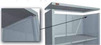
9. Установить перегородки. Установку перегородок рекомендуется начинать с самой верхней. Верхние перегородки отличаются от нижних наличием на верхней отбортовке двух прямоугольных отверстий. Верхнюю перегородку завести верхней отбортовкой под фиксирующую полосу крыши и задвинуть до защелкивания замков. Затем соединить верхнюю перегородку с нижней с помощью двух винтов М5х10 с гайками (сквозь отверстия в полке). Самую нижнюю перегородку соединить с дном с помощью двух саморезов.
