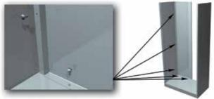
6. Установить правую заднюю стенку, соединив ее с левой задней стенкой с помощью трех саморезов, с правой боковой стенкой – с помощью трех саморезов и с дном – с помощью двух саморезов.
