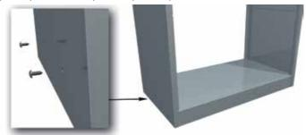
4. Положить изделие на горизонтальную поверхность передней частью вниз. Соединить боковые стенки с дном с помощью четырех винтов М5х16. После этого вернуть изделие в вертикальное положение.
