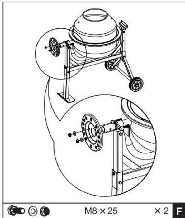
1. Сдвиньте стопорную пластину на вал большого диаметра на конце лапы рамы, при этом обод будет обращен внутрь, как показано на рисунке. Закрепите двумя болтами М8Х25, каждый с плоской шайбой и контргайкой.
