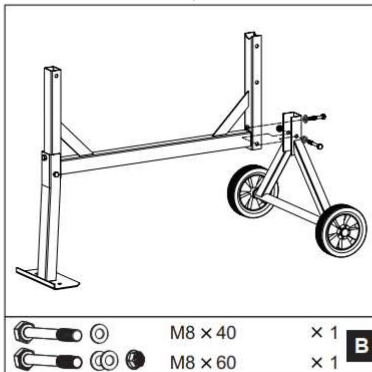
2. Переверните раму и закрепите кронштейн оси колесами таким же образом.
