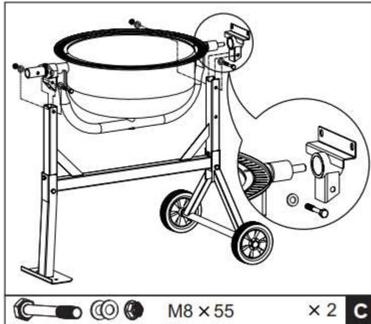
1. Осторожно, вдвоем, установите нижний барабан с опорным рычагом на боковые опоры станда, как показано на рисунке, так, чтобы блоки подшипников вставлялись в каналы, предусмотренные боковыми опорами. Вал большего диаметра должен находиться на конце ножки подставки.
