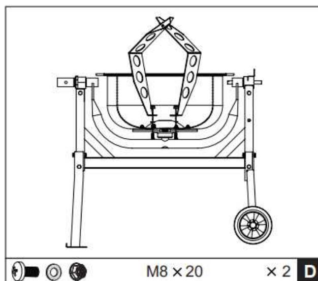
Установите смесительные лопасти внутри нижнего барабана свободно, как показано на рисунке - В основании барабана предусмотрены два отверстия, в которые снаружи можно вставить винт с крестообразной головкой М8Х20. Кожаная
