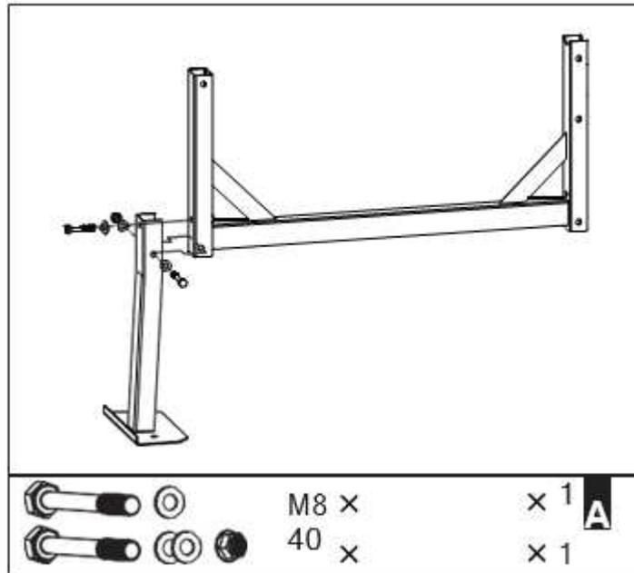
1. С рамой, лежащей на боку, закрепите опорную ногу, как показано на рисунке. Вставьте болт М8Х60 с шестигранной головкой через отверстия с одной стороны, затем плоские шайбы и контргайку, с другой стороны. Также прикрутите болт М8Х40 с плоской шайбой к гайке на раме. Затяните.
