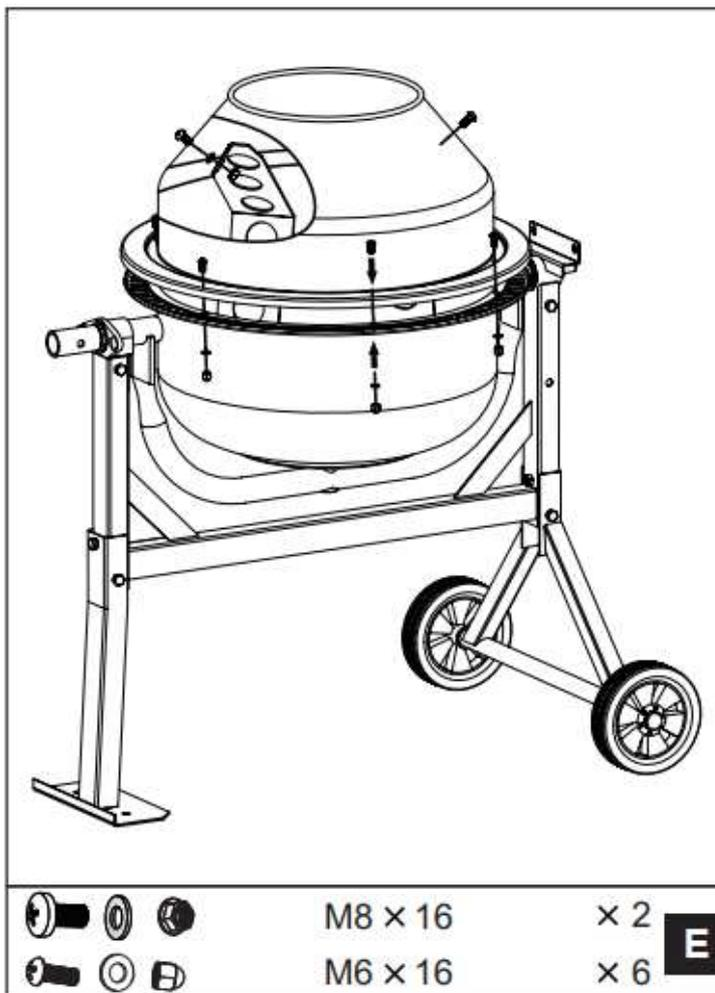
1. Расположите верхний барабан на нижнем барабане над ободом, убедившись, что монтажные отверстия совмещаются как в обоих, так и в обозначенных стрелках.
