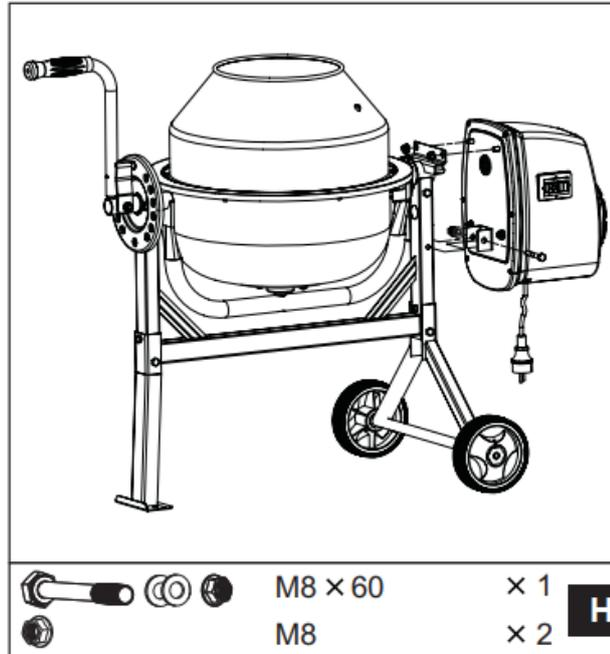
Аккуратно установите блок двигателя на вал бетоносмесителя. Убедитесь в том, что крепежные болты, находящиеся на блоке двигателя, вошли в крепежные отверстия. Накрутите гайки М8 на болты, предварительно установив плоские шайбы и стопорные шайбы. Убедитесь в том, что все гайки плотно затянуты.
