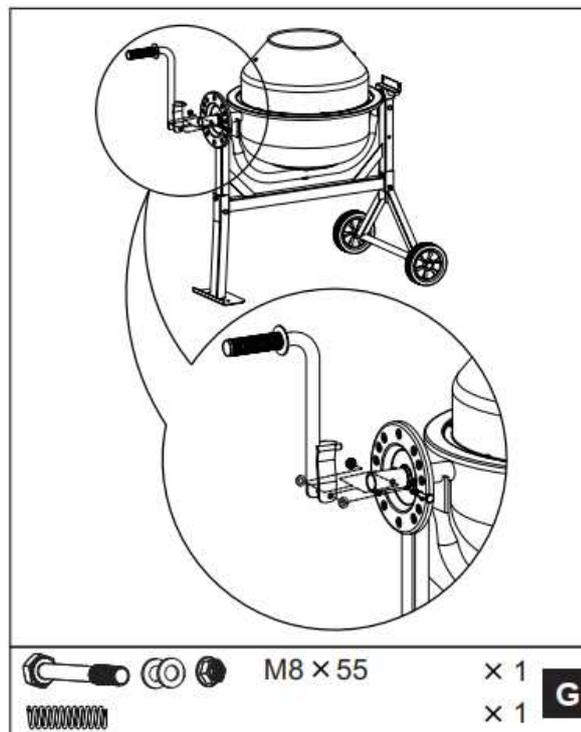
2. Вставить пружину в трубу штанги. Удерживая ее пальцем, поместить пружину на вал большего диаметра таким образом, чтобы вал удерживал пружину. Надавите на штангу до тех пор, пока отверстия в кронштейне не выровняются с просверленным отверстием. Вставить болт М8Х55 с шестигранной головкой и закрутить контргайку плоскими шайбами, с другой стороны. Закрутите гайку на кронштейне жестко, но не настолько сильно, чтобы стержень не поворачивался
