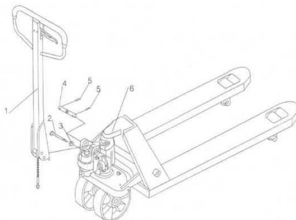
Рис. 5: Монтаж ручки
