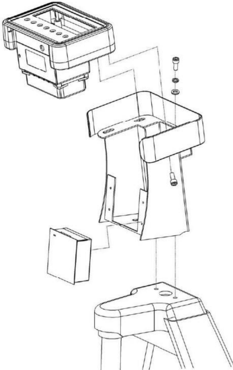
Рис. 7: Монтаж весового терминала
