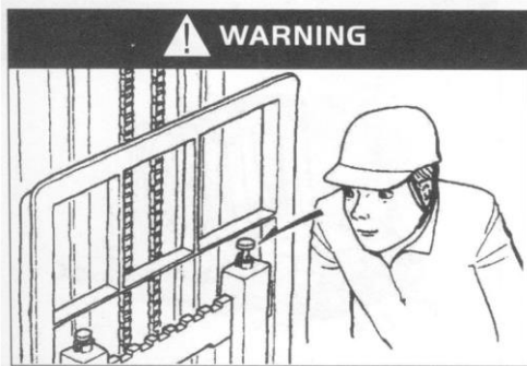
Проверьте положение штифта на раме вилок
