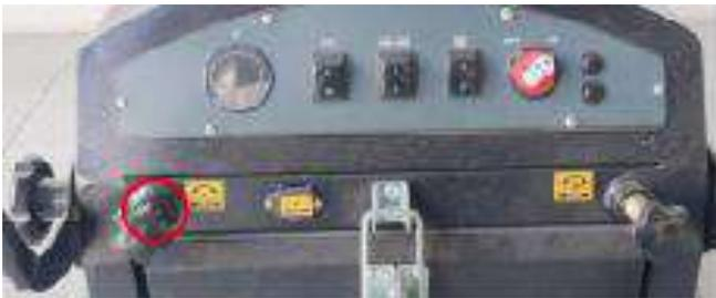
Высота боковой щетки регулируется на заводе-изготовителе. Однако после некоторого периода использования, если боковая щетка не очищает поверхность должным образом, ее высоту необходимо отрегулировать. Поверните рукоятку
