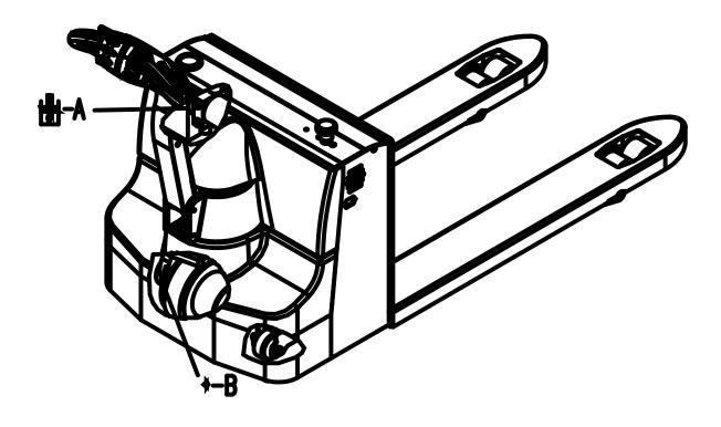
Отверстие для заливки гидравлического масла Отверстие для заливки трансмиссионного масла
