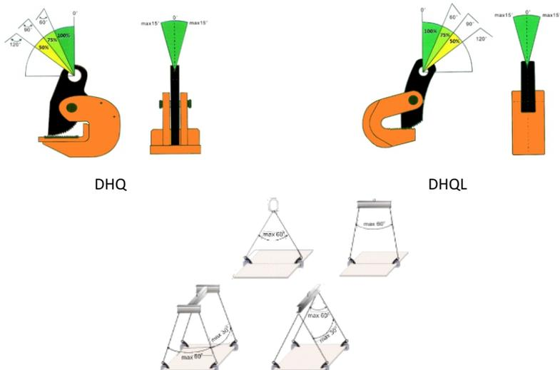
Рисунок 2. Рабочая нагрузка в соответствии с различными углами
