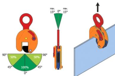
**Рисунок 4. Рабочая нагрузка в соответствии с различными углами**
