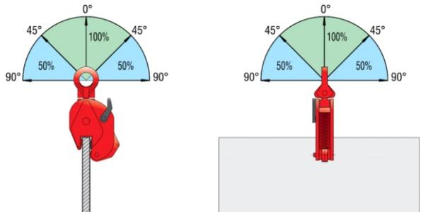
**Рисунок 6. Рабочая нагрузка в соответствии с различными углами**
