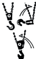
Рис. 5 Неправильное положение крюка
